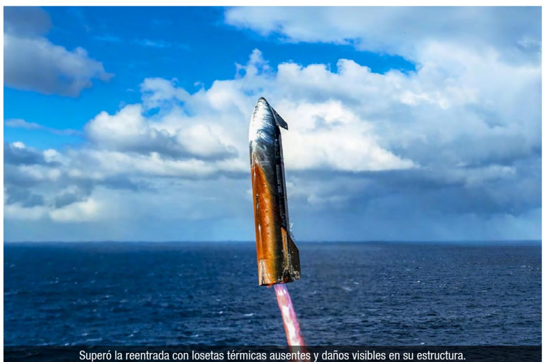
Superó la reentrada con losetas térmicas ausentes y daños visibles en su estructura.
