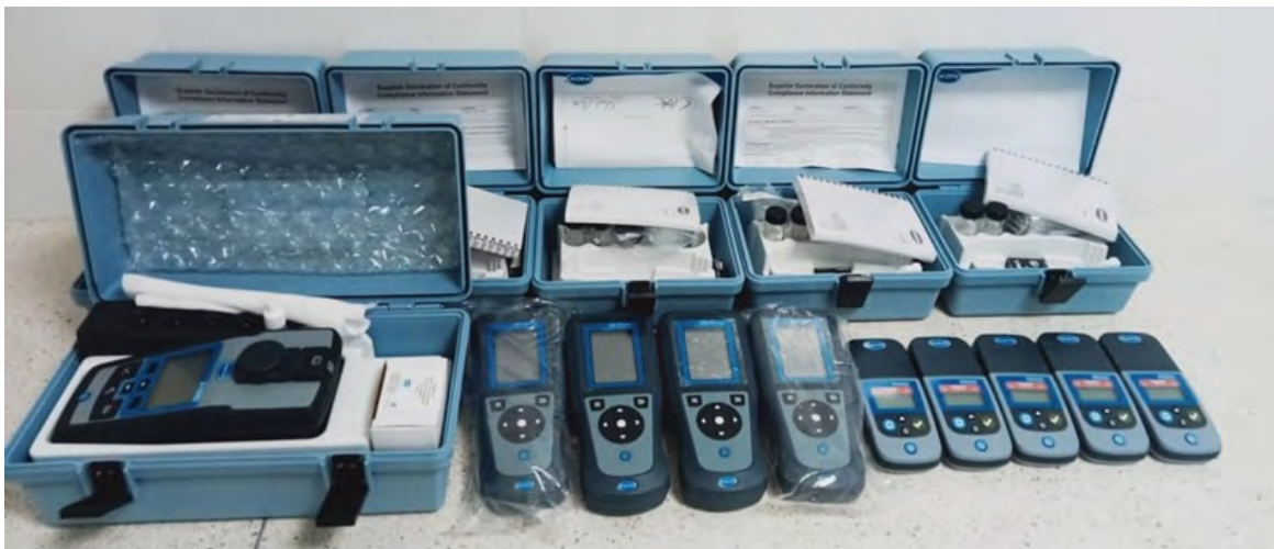
Los nuevos equipos permitirán medir parámetros como turbidez, cloro residual y pH, asegurando un control de calidad más eficiente del agua potable distribuida a los usuarios de la región.
