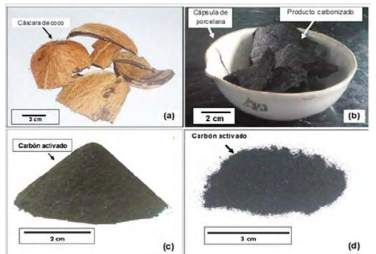
Proceso de preparación del Carbón Activado de cáscara de coco
