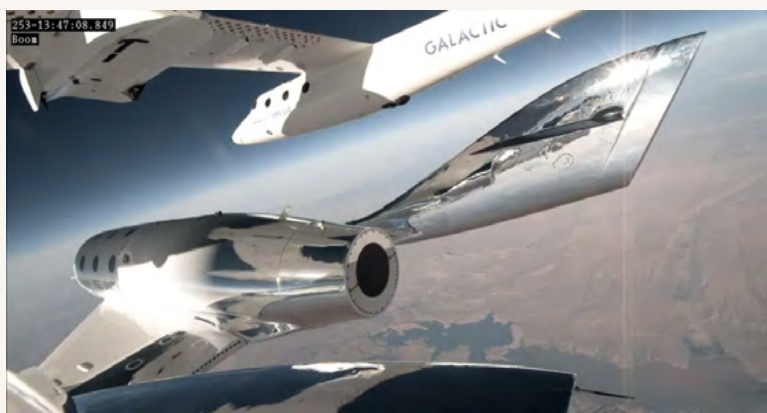
Fotografía cedida por Virgin Galactic donde se aprecia la nave VSS Unity mientras se separa de la nave nodriza VMS Eve durante un vuelo de prueba de planeo sin motor sobre el sur de Nuevo México (EE.UU.).
